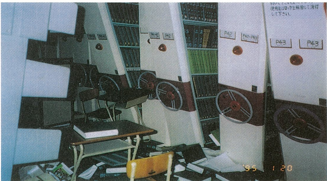
傾斜した集密書架 手動式集密書架がレールと直角方向に傾斜し、作動不能となった。
